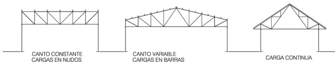
Figura 6.4 Elementos de una celosía
