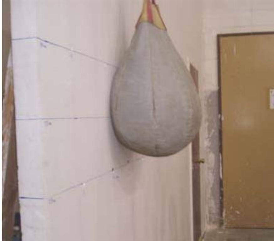
Impacto con un saco de 50 kg liberando una energía de hasta 300 Nm
