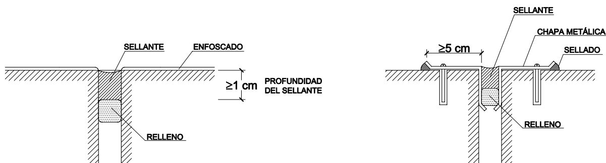
Figura 2.6 Ejemplos de juntas de dilatación
